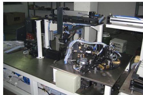
挺柱体组件自动检测和打标装置
